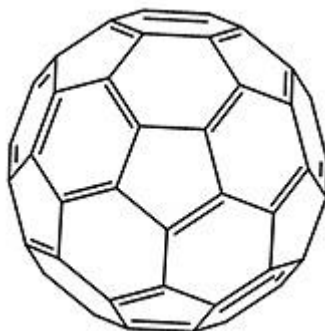
Figur 1. Ett nödvändigt villkor för en stabil kolmolekyl är att varje kolatom, som markeras av ett hörn i figuren, har fyra streck till intilliggande hörn. Detta fungerar i den fotbollslänkande fullerenen. Denna komplicerade molekyl har syntetiserats i laboratorier, men den finns också i vanligt sot.
