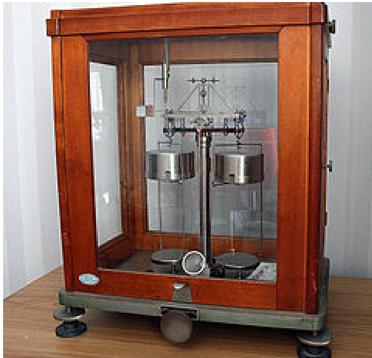
Figur 3.7: Analysvåg 30-tal. Sådana utgjorde gränsen för vad som gick att mäta. Bild: Wikipedia.
