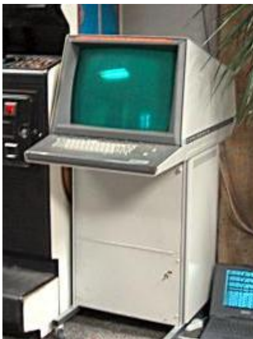
Figur 11.5: Tektronix-terminal 4014. Man kunde dra linjer från och till någon av 1024 \cdot 1024 pixlar, enormt på den tiden. Bilden låg i fosfor i katodstråleröret, så man behövde inte använda dyrt minne för bilderna.
