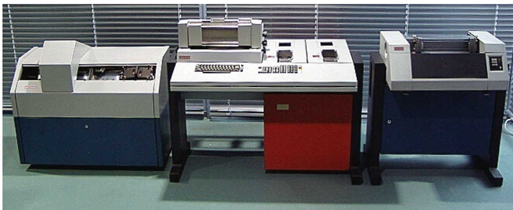
Figur 10.3: Nixdorf 820 minidator. Systemet var modulärt uppbyggt. Här visas en konfiguration med hålkortsstans (vänster), snabb matris skrivare (höger) och konsol med hålkortsläsare i mitten.
