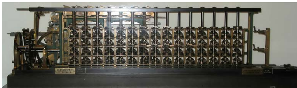
Figur 7.3: Georg Scheutz tredje differensmaskin från 1850-talet. Bild: https://en.wikipedia.org/wiki/Difference_engine
