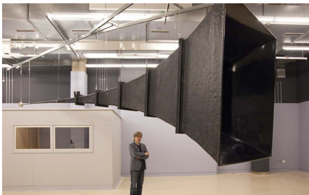
Figur 8.10: Exponentialhorn. Historiens största högtalare åter i drift. Det demonstrerades på en nu avslutad utställning. Originalen byggdes på 30-talet, men blev förstört under kriget.
