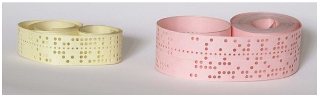
Figur 8.4: Håltremsor, 5- och 8-kanaler. BESK hade 5-kanalsremsor. En 5-bitskod räckte inte, ens med bokstavsskift och sifferskift. D21 hade 8-kanals håltremsa, vilket passade bättre med IBM:s arkitektur.
