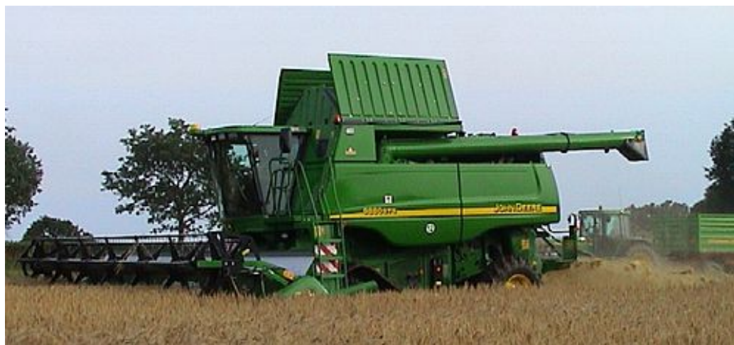
(b) Skördetröska. Skördetröska ger tröskad säd efter en runda på åkern. Två man behövs: En kör tröskan, en kör en traktor med vagn att tömma sädeskornen i. Maskinerna är dyra. För att nå lönsamhet behövs stora gårdar. Bild: Wikipedia, Skördetröska.
