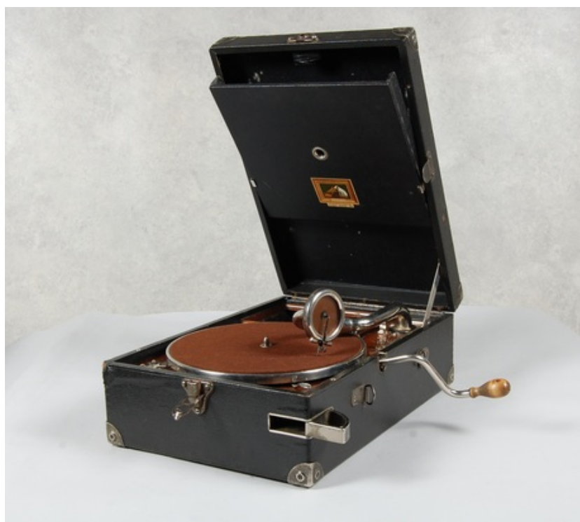
Figur 8.17: Resegrammofon 1920 – 1930-tal. En sådan hade min Pappa. Ingen elektricitet användes. Grammofonen drogs upp för hand. När fjädern var nästan slut, gick skivtallriken långsammare och tonhöjden sänktes. Nålen var av järn och skulle bytas mellan varje uppspelning. Pickupen var tung och repade skivorna. De gamla 78-varvsskivorna blev fort raspiga. Ljudkvaliteten var bedrövlig. Bild: auctionet.com .
