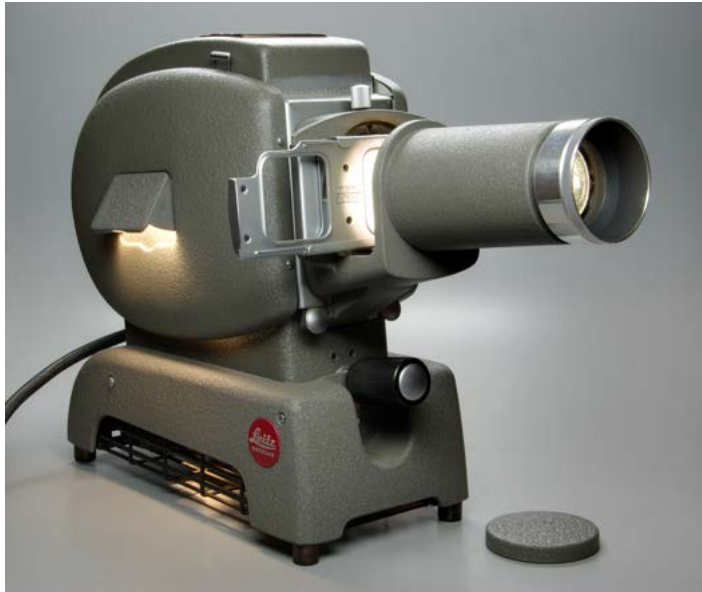
(a) Manuell diaprojektor eller skioptikon , som man sade i min barndom. Bildbyte gjordes i facket utanför ljusvägen så föreställningen stördes inte. Bild: https://de.wikipedia.org/wiki/Leica_Camera
