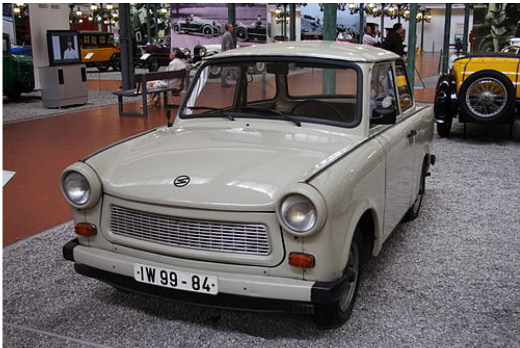
Figur 6.6: Trabant 601. Plastkaross, framhjulsdreven, tvåtaktare, 26 hk motor. Det var mycket långa leveranstider. Duktiga ingenjörer gjorde vad de kunde i en svag ekonomi trots motstånd från politisk ledning. Från början var Trabanten inte mycket sämre än en Volkswagenbubbla. I slutet av 80-talet blev bilen en symbol för hur långt östblocket hade halkat efter. Bild: Wikipedia.
